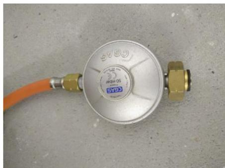
Zum Anschluss einer Gasflasche an einen Gasgrill werden ein Schlauch mit einer Länge von 80 cm und ein Regler 30 mbar benötigt. Schlauch und Regler sind bei den meisten Grills im Lieferumfang enthalten.
